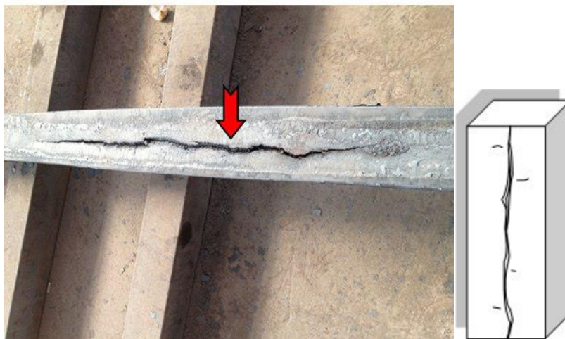
ترک عرضی در گوشه شمش (CROSSWISE) CORNER CRACK
