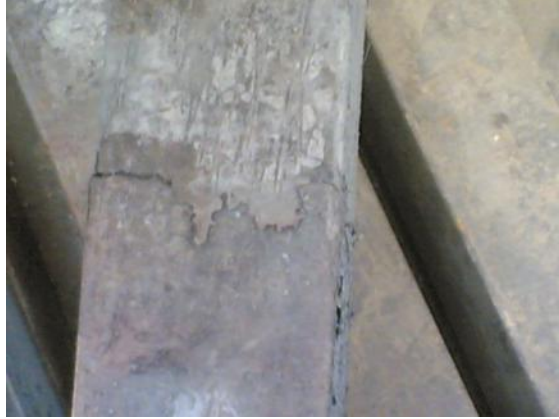
(شکل بالا) عیب کمربندی ناشی از توقف ذوب ریزی
