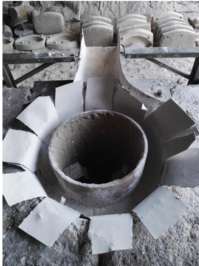
شکل ۷- شابلون داخل کوره قرار داده شده و فرایند کوبیدن دیواره ها در مرحله پایانیست.
