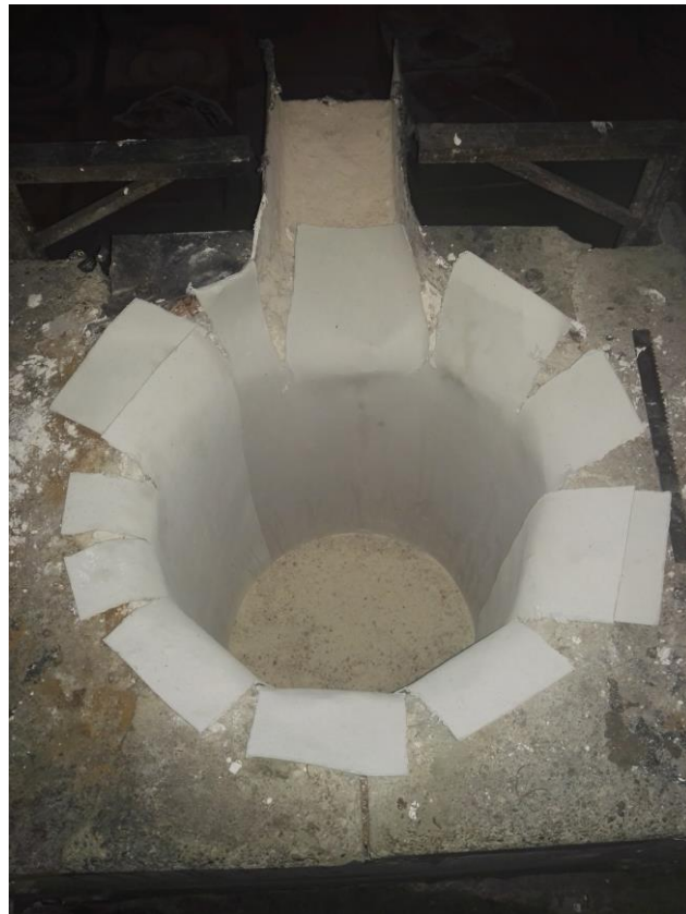
شکل ۲-نمایی از عایق آزبست قرار داده شده به دیواره کوره
