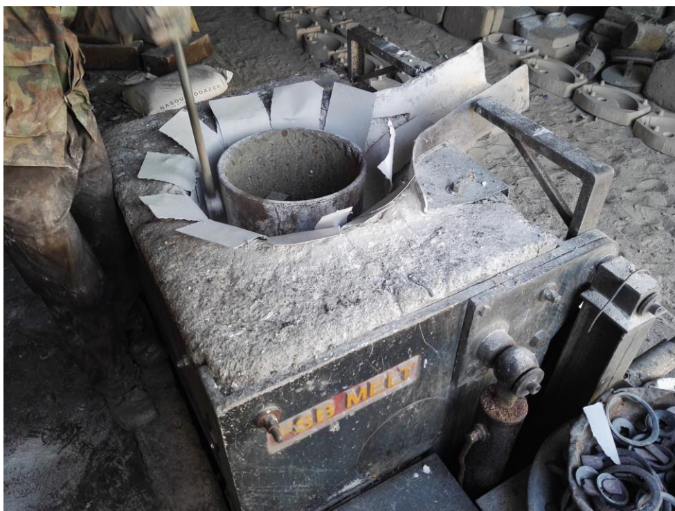
شکل ۸- کوره بان در حال کوبیدن دیواره کوره با ابزار کمانی
